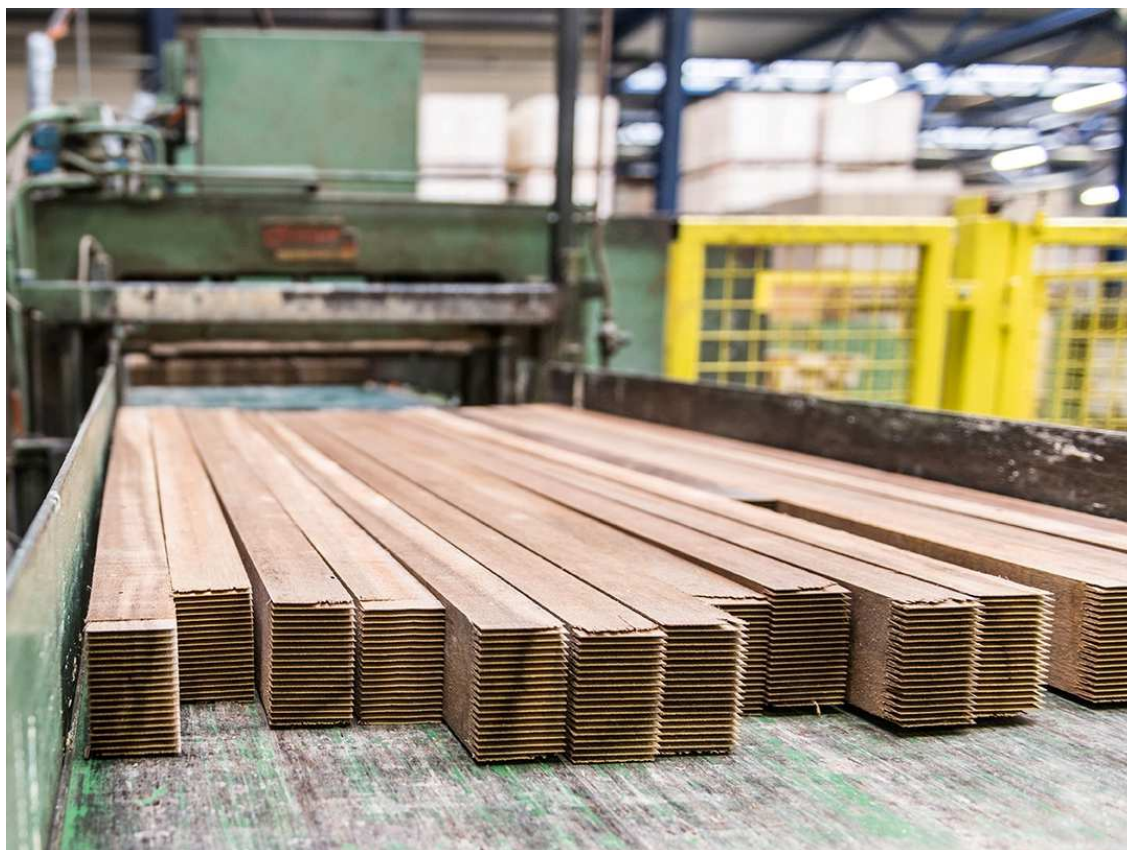
Foto 1: Shorts liggen klaar om gevingerlast te worden. Foto: GluGreen BV
